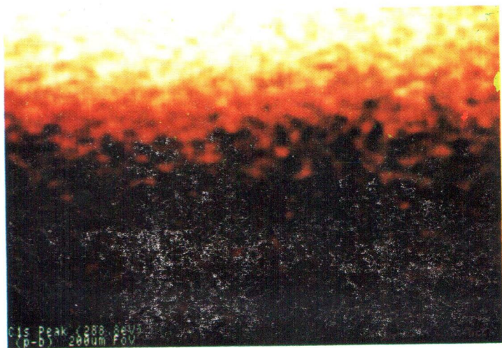
彩图 2 PyDDP-C 60 LB 膜中 C 1s (288.8eV 处)的 X 光电子图象
